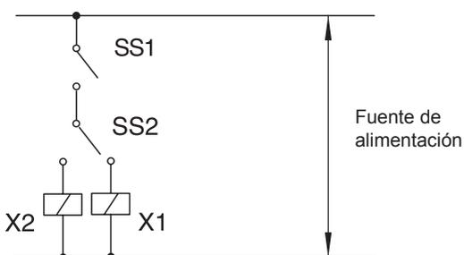
SS1: Interruptor de fijación del modo de funcionamiento
