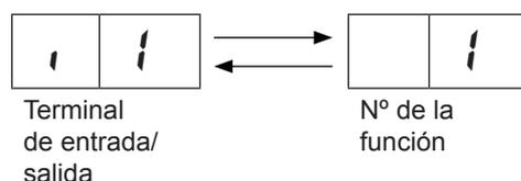
Esto indica que la función nº 1 (ajuste del modo de calefacción) se ha ajustado en la entrada 1.
